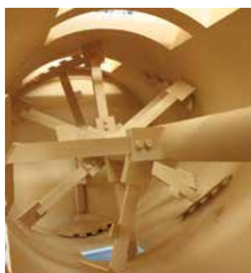
Специальное расположение смесительных элементов в зависимости от применения
