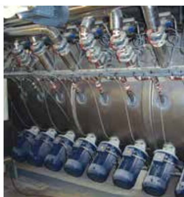
Деагломераторы, ввод жидких компонентов, термокожух
